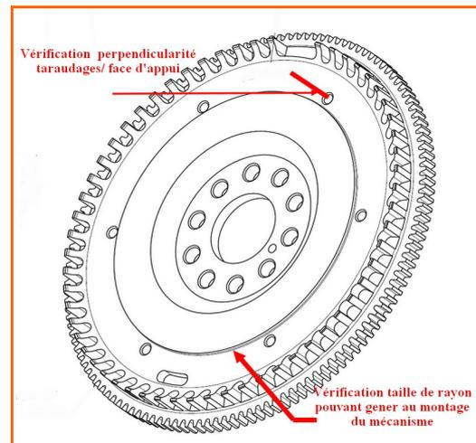
=>Vérifier l'absence de rayon à la jonction de l'épaulement du centrage du mécanisme par rapport à la face d'appui du mécanisme (un rayon trop important empêchera le plaquage correct du mécanisme à cet endroit ).
