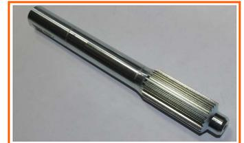
Le mauvais centrage de ceux -ci risque de reculer l'arbre d'embrayage de la boîte de vitesses
