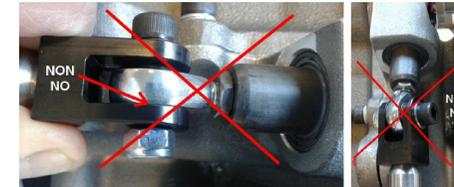
2 - La rotule n'est pas centrée par rapport à la chape, non-parallèle à la face moteur/boîte ou non alignée. Ces montages créent des efforts parasites entravant le coulissement de l'axe de commande, ce qui ralentit considérablement la vitesse de passages des rapports, et a pour conséquence l'usure prématurée des crabots.
