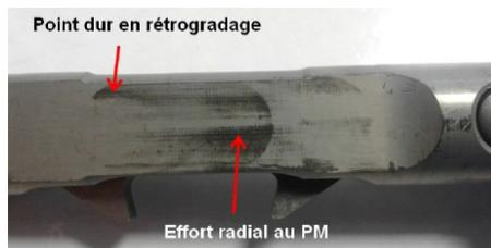
1 - L'ensemble de la barre de commande n'est pas ligne avec l'axe de commande. Ceci crée un effort de basculement de l'axe de commande qui ralentit considérablement la vitesse de passages des rapports, et a pour conséquence l'usure prématurée des crabots :
