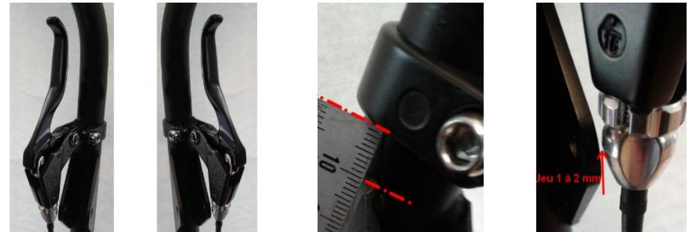
2→ Positionnement de la fixation de la poignée 30mm au dessus du support d'attelage du levier : l'orientation droite/gauche de la poignée doit être réalisée de manière à ce que le centre de l'axe d'articulation de la poignée soit dans le prolongement de la face intérieure du support d'attelage (à gauche pour montage à gauche, et à droite pour montage à droite)
