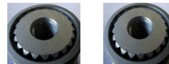
→ **Cas N°2 :** L'arbre est correctement positionné, la face de l'arbre d'embrayage est au même niveau que la fin du chanfrein d'entrée de l'arbre primaire. Dans ce cas aucune intervention n'est nécessaire, l'arbre est correctement monté.
