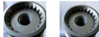
→ **Cas N°3 :** L'arbre est trop rentré. Cela se produit généralement lorsque la remise en position de l'arbre est trop virile ou le jonc de verrouillage trop faible. La cause de ce dernier cas pouvant être l'usure ou le non remplacement du jonc (systématique après révision ou démontage de l'arbre d'embrayage).
