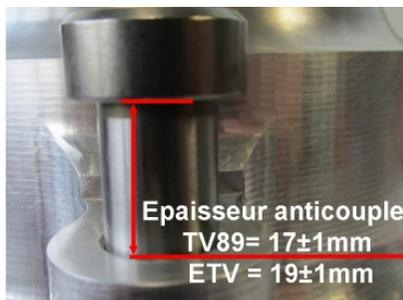
Le diamètre de guidage des deux trous de fixation sur votre anti couple doit être de  $\varnothing 12$  H8. Le taraudage à l'intérieur du carter de la BV est M10x1,5 renforcés par des Hélicoils remplaçables (Référence des hélicoils : 212000007)
