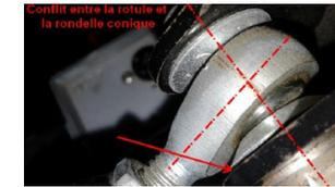
Il est également nécessaire de vérifier la fixation de l'embase du levier et la rigidité du tunnel. En effet le levier risquerait de bouger en latéral à chaque changement de rapport, ce qui donnerait une impression de passage feutré avec peu de précision et des irrégularités sensorielles.
