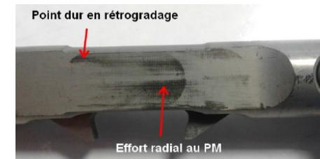
1 - L'ensemble de la barre de commande n'est pas ligne avec l'axe de commande. Ceci créé un effort de basculement de l'axe de commande qui ralentit considérablement la vitesse de passages des rapports, et a pour conséquence l'usure prématurée des crabots :
