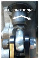
Ci-suit un exemple d'axe de commande marqué suite à un mauvais alignement de la barre de commande au point mort et d'une rotule en contrainte sur le bord de la chape au rétrogradage. Ce qui force l'axe à effectuer une rotation supérieure à sa limite requise. La conséquence directe est une usure prématurée des crabots liée au ralentissement de sa fonction de déplacement.
