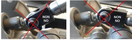
2 - La rotule n'est pas centrée par rapport à la chape, non-parallèle à la face moteur/boîte ou non alignée. Ces montages créent des efforts parasites entravant le coulissement de l'axe de commande, ce qui ralentit considérablement la vitesse de passages des rapports, et a pour conséquence l'usure prématurée des crabots.
