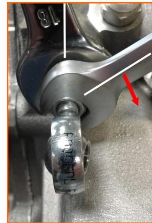
Le dernier contrôle consiste à assurer un jeu axial dans toutes les positions de l'axe de sélection lorsque tout est monté définitivement sur le véhicule (rotule/chape et barre de commande).
