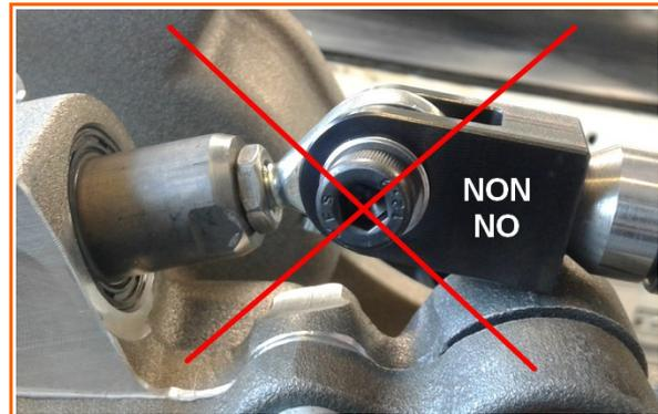
Ceci crée un effort de basculement de l'axe de commande qui ralentit considérablement la vitesse de passage des vitesses et souvent pour conséquence une usure prématurée des crabots ;
