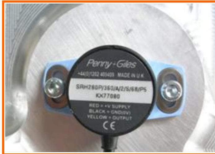
**!/ Ne pas confondre avec le capteur Penny&Giles noir pour lequel le câblage est différent :**
